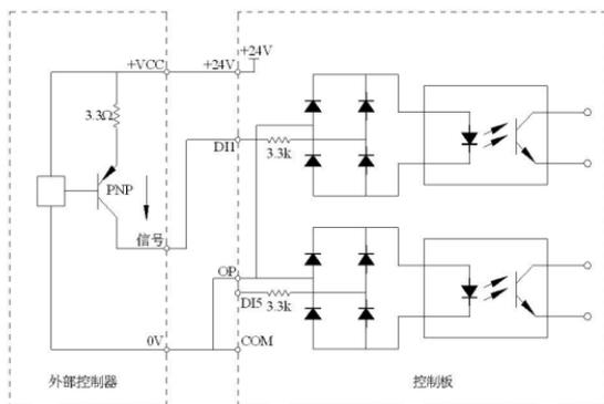
这种接线方式必须把跳线 J9 的 OP 跳到 COM 上，把+24V 与外部控制器的公共端接在一起。如果用外部电源，还必须把外部电源的负极接在 OP 上。
