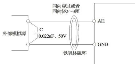
模拟量输入端子处理接线图
