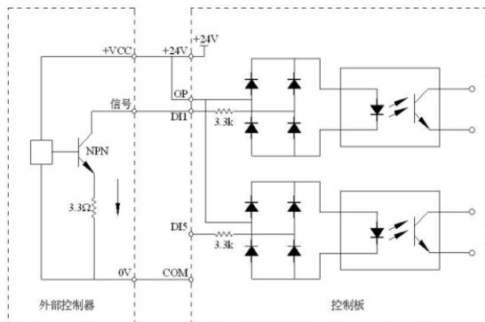
这是一种最常用的接线方式。如果使用外部电源，必须把+24V 与 OP 间的跳线 J9 去掉，把外部电源的正极接在 OP 上，外部电源的负极接在 COM 上。
