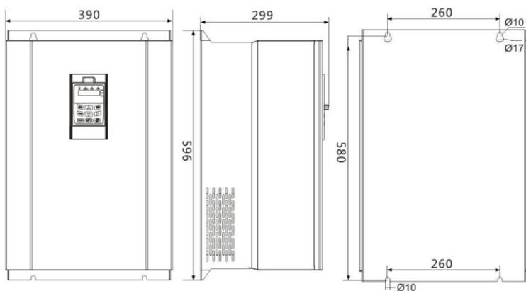
三相 220V: 18.5kW-30kW; 三相 380V: 37kW-55kW
