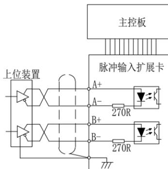
这种信号传输方法有更好的抗噪声性能，推荐使用这种脉冲输入方式。
