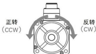
当电机运转方向跟上图不一致时，请调换电机任意两相线，同时修改编码器方向参数 Pn6.03，并重新对电机进行参数自学习。
