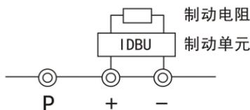
③55kW 及以上（三相 220V），110kW 及以上（三相 380V），制动单元及外置电抗器接线端子为：
