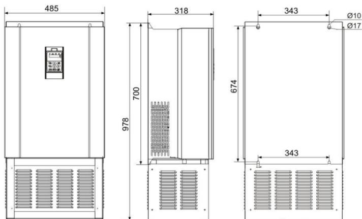
三相 220V: 37kW-45kW; 三相 380V: 75kW-90kW
