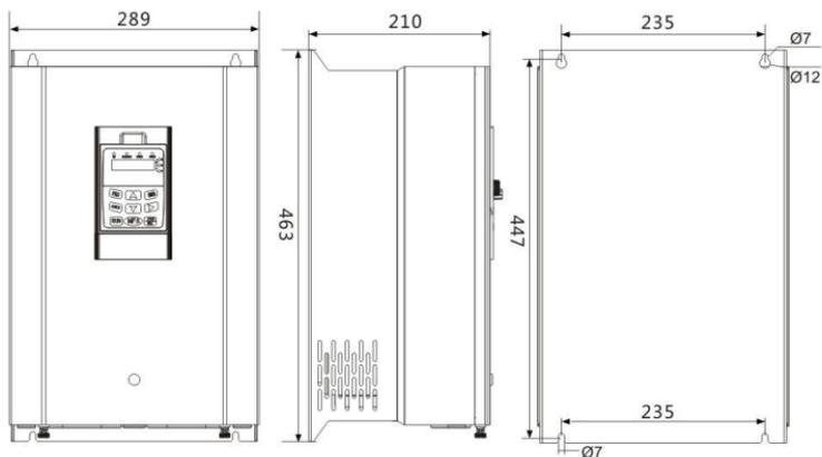
三相 220V: 11kW-15kW; 三相 380V: 18.5kW-30kW
