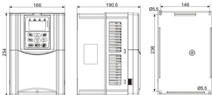
单相 220V: 2.2kW; 三相 220V: 2.2kW-4kW 三相 380V: 4kW-5.5kW
