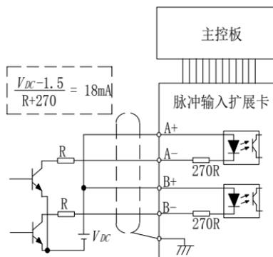
这种方法使用了一个外部控制信号电源  $V_{DC}$ 。在这种方法中，要求符合电源要求的限流电阻  $R$ 。
