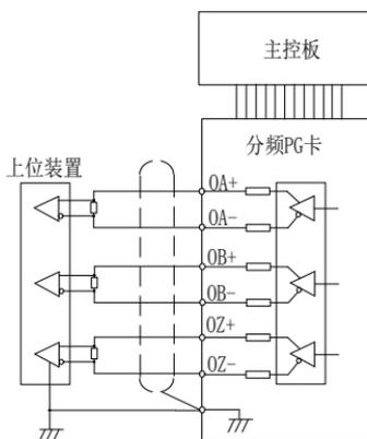
差分输出编码器的 A、B、Z 信号，可通过 PG 卡的拨码开关调节分频系数。在接收器的输入间务必接一终端电阻（约 330R）
