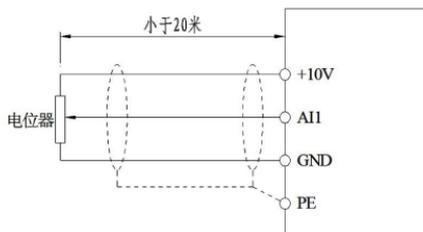
模拟量输入端子接线示意图
